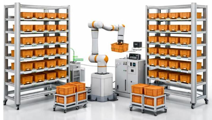
de control está integrado por una estación descentralizada de Profinet, la cual recibe las señales de ocupación de las bahías de los almacenes. Esta configuración permite integrar al sistema de almacén de materiales a dos frentes con robot a un sistema de PLC.
