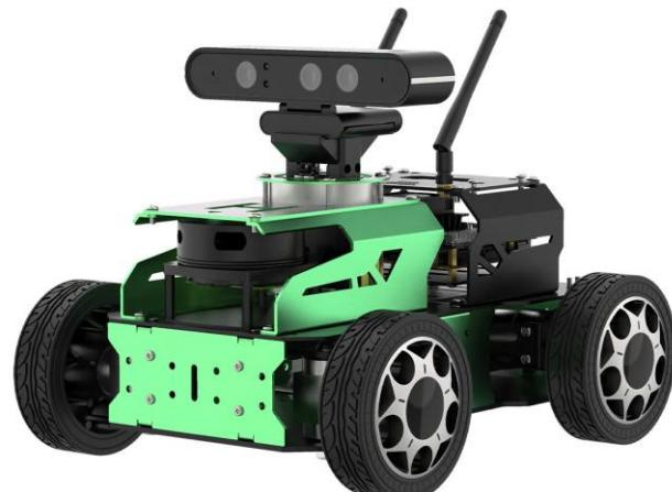
El Robot de transporte 4.0 utiliza una vez configurado, avanzados algoritmos de mapeo para dar guía a su movimiento dentro del área de trabajo. Con este tipo de Robots autónomo ya no se requiere de una infraestructura fija de cableados y espacios restringidos, lo que da una mayor agilidad al flujo de materiales para dar una expedita atención de la demanda.
